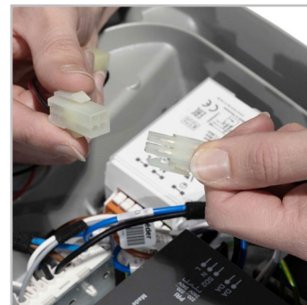
Poke-yoke konektori za laku integraciju bez kvarova u TECEO 1 svjetiljke
