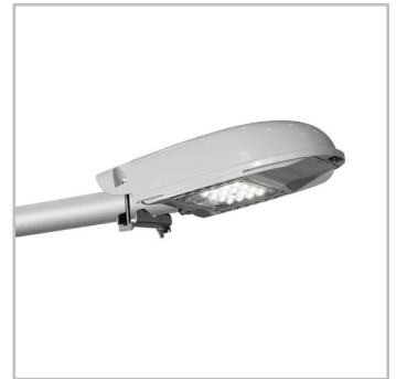
Precizno podešavanje na licu mesta. Ugao nagiba se može podesiti od -15° do +5° za bočnu montažu i od -10° do +10° sa adapterom za montažu na vrhu stuba.
