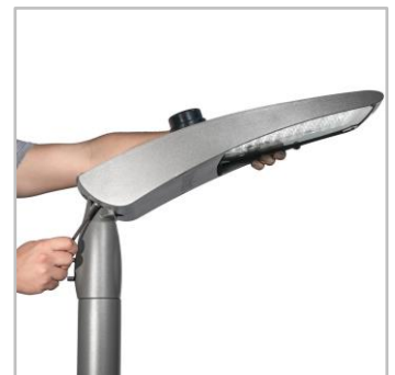
Ugao nagiba se može podesiti na licu mesta, kako pri montaži na vrhu stuba (0 do +15°) tako i pri bočnoj montaži (0 do -15°).
