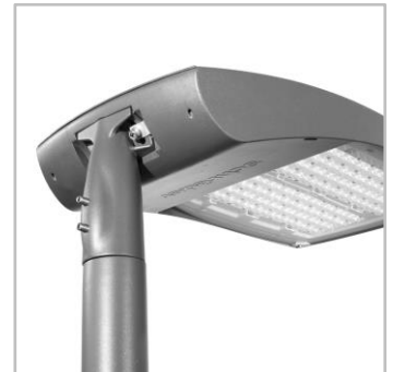
Familija svetiljki TECEO GEN2 omogućava univerzalnu montažu za različite završetke stuba od Ø32 do Ø76mm. Takođe je na raspolaganju i namenski adapter Ø60mm.
