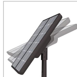
Optimizacija prikupljanja sunčeve energije i distribucije svetlosti na licu mesta zahtevaju drugačiju podešavanju. Ovo se može postići samo kada su solarni panel i svetiljka odvojeni. Schréder EKINOX omogućava ovu fleksibilnost u okviru svog dizajna, jer se solarni paneli mogu nagnuti do optimalnog ugla, u rasponu od 0 do 50° (u zavisnosti od izabranog SE solarnog kompleta).
