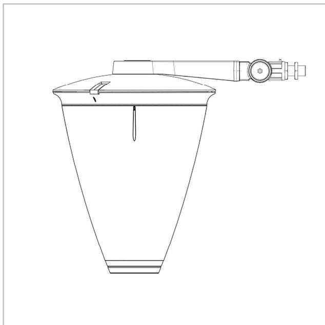
FLEXIA DP | Zglobni nosač za bočnu montažu sa ženskim završetkom prečnika R1"(A4)
