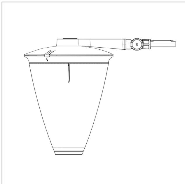
FLEXIA DP | Zglobni nosač za bočnu montažu na ravnu površinu sa pravougaonim završetkom 60x50 mm (A2)
