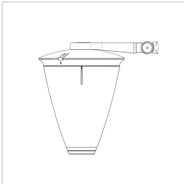
FLEXIA DP | Zglobni nosač za bočnu montažu sa muškim završetkom prečnika R1"(A3)
