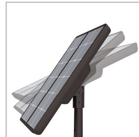
Optimizacija prikupljanja sunčeve energije i distribucije svetlosti na licu mesta zahtevaju drugačija podešavanja. Ovo se može postići samo kada su solarni panel i svetiljka odvojeni. Schréder EKINOX omogućava ovu fleksibilnost u okviru svog dizajna, jer se solarni paneli mogu nagnuti do optimalnog ugla, u rasponu od 0 do 50° (u zavisnosti od izabranog SE solarnog kompleta).
